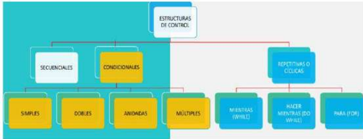
Figura 58. Tipos de estructuras de control
